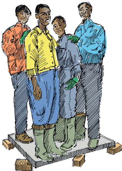
Figure 27. Tester la dalle
