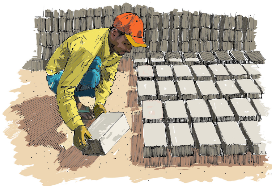
Figure 7. Fabrication locale de blocs séchés au soleil
