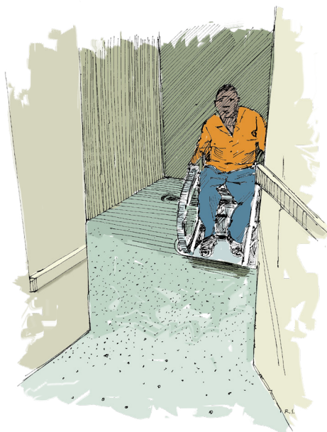
Figure 4. Latrine avec une ouverture large et assez d'espace pour qu'un fauteuil roulant puisse tourner
