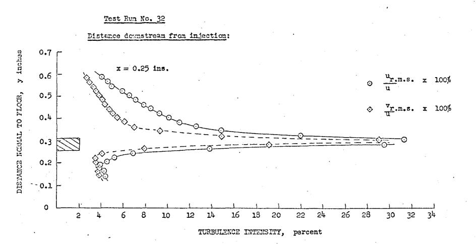
FIG. 10.6: INTENSITY PROFILES FOR THIN - LIPPED SLOT, um < u. TURBULENCE
