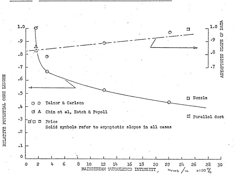
FIG. 2.14: EFFECT OF MAINSTREAM TURBULENCE ON POTENTIAL CORE LENGTH
