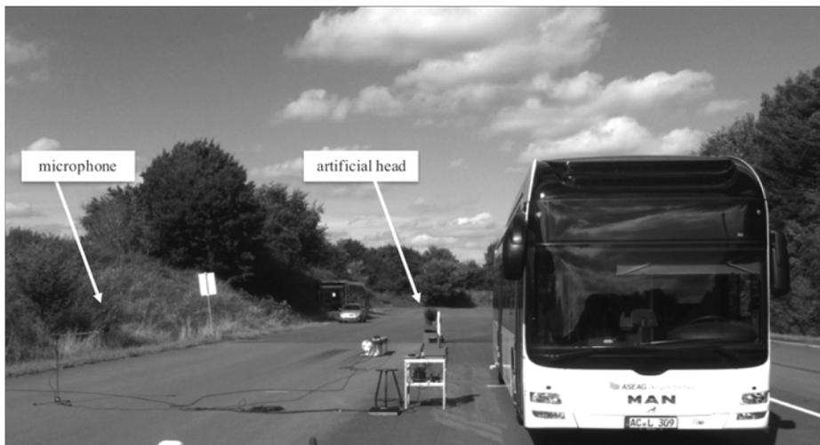
Figura 10. Configuración de los ensayos exteriores en autobuses eléctricos [15]
