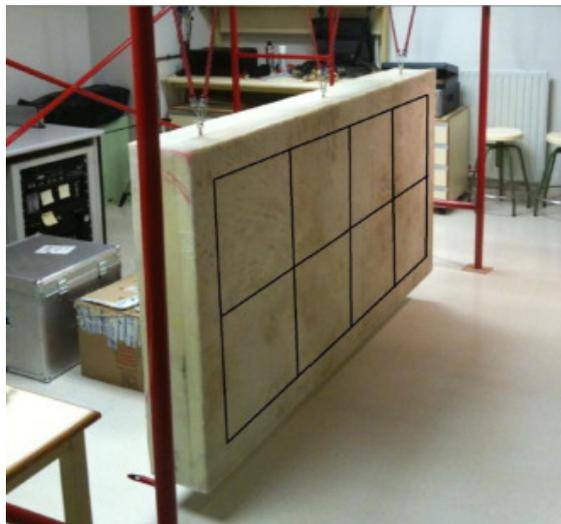
Figura 5. Muestra de material ligero dispuesto para su ensayo (condiciones de contorno y malla con los puntos de ensayo) [14]
