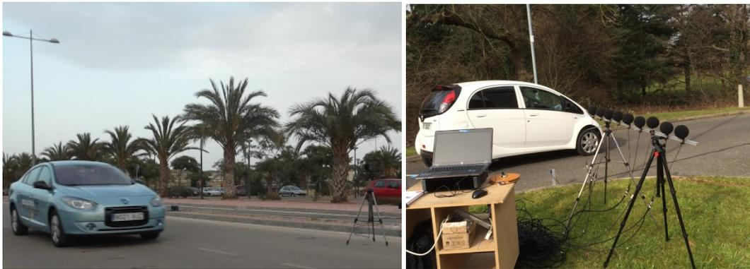
Figura 14. Ensayo pass-by y pass-by con array de sendos vehículos eléctricos [20][21]
