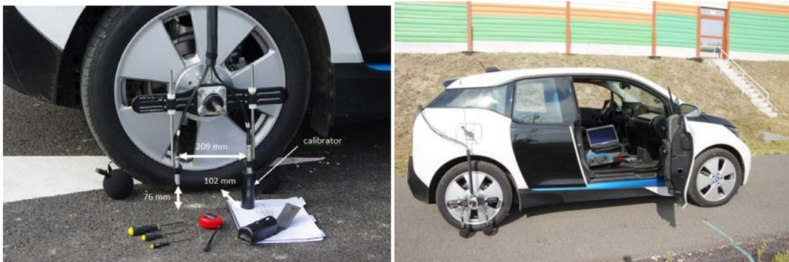
Figura 12. a) Sondas de intensidad sonora instaladas en la rueda [19]. b) Configuración OBSIe instalada en un BMW i3 [19]
