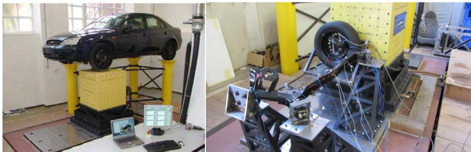
Figura 9. Imágenes del “CUBE” en ensayos experimentales de vehículos y componentes [17]
