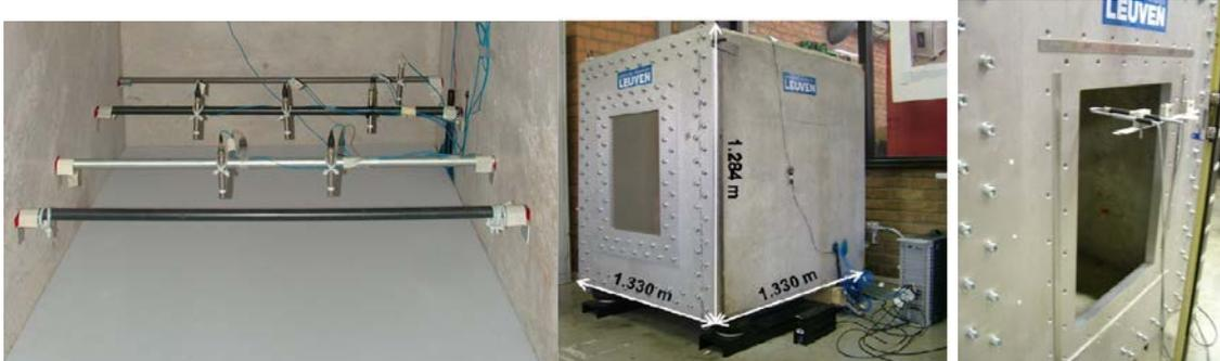
Figura 3. Cabina de ensayo para la caracterización vibro-acústica de materiales ligeros [12]
