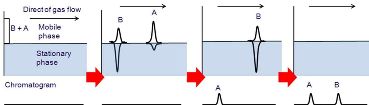
**Figure 1.6.4.1.1.1. The GC separation process**
