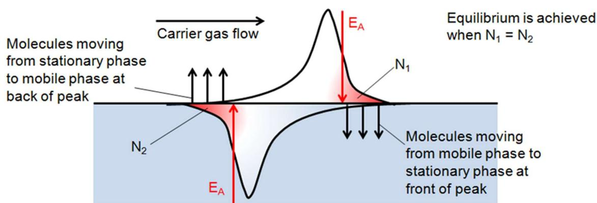
**Figure 1.6.4.1.1.2. The elution process**
