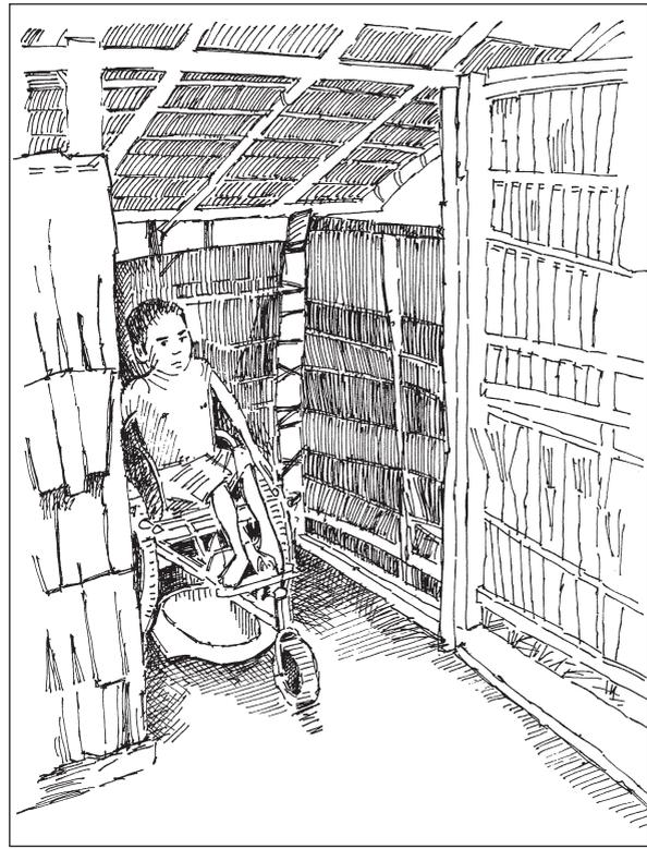
Figure 5.26. Des sanitaires suffisamment spacieux pour positionner le fauteuil roulant au-dessus des sanitaires, et non à côté. L'utilisateur doit y entrer en « marche arrière ».
