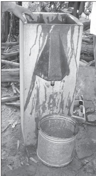
Figure 9.59. Un filtre à sable pour l'eau.
