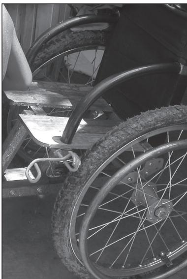
Figure 9.75. Une assise du fauteuil roulant dépourvue de planche centrale.
