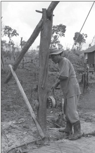
Figure 9.48. M. Ath actionne la poignée du dispositif afin de baisser et de soulever le seau.
