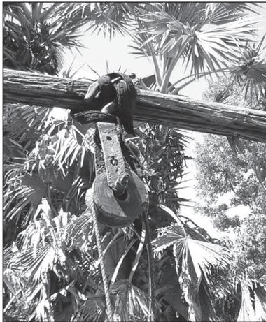
Figure 9.52. Une poulie en bois et en métal fabriquée localement.
