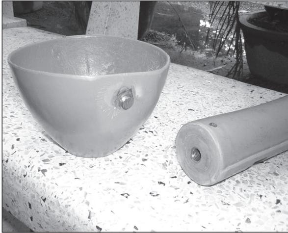
Figure 6.77. Un accessoire à fixer par vissage sur un bol pour un bras artificiel.
