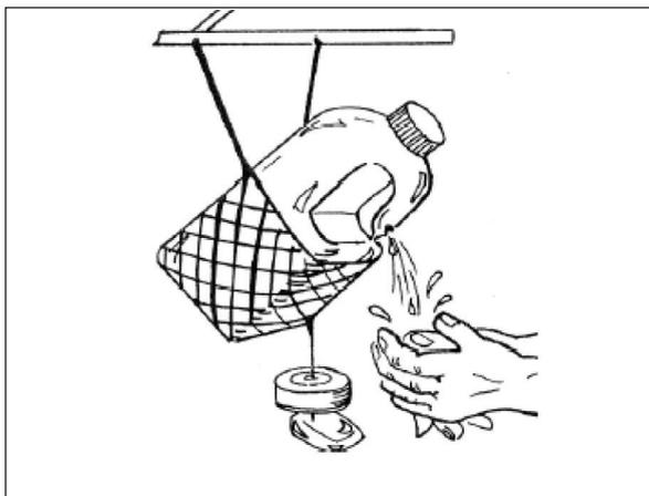
Figure 6.40. Un robinet à bascule pour le lavage des mains.
