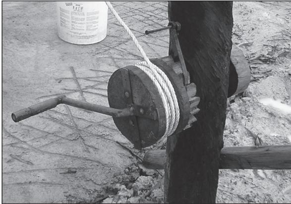
Figure 6.9. Le détail du dispositif à rochet permettant de puiser l'eau.
