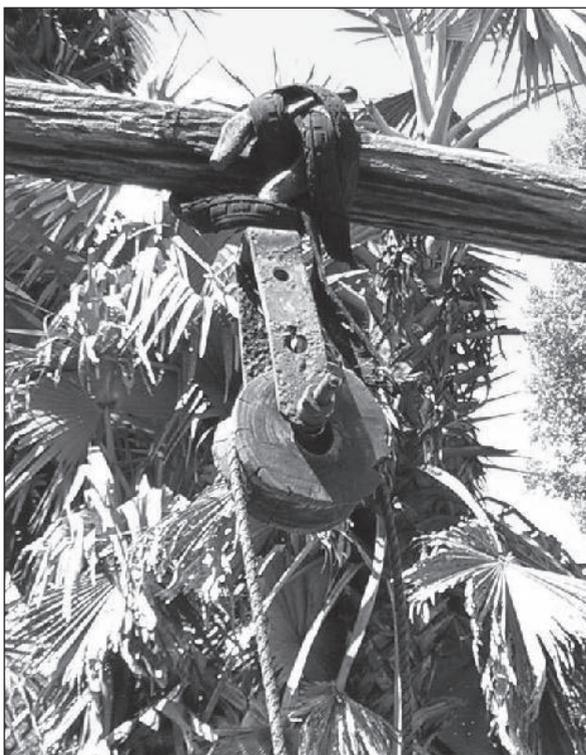
Figure 6.8. Le détail du mécanisme d'élévation par poulie.
