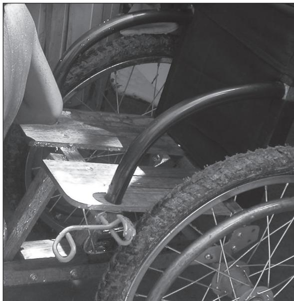
Figure 7.40. Un fauteuil roulant dont la planche centrale a été supprimée pour permettre de faire sa toilette sur le fauteuil.\*
