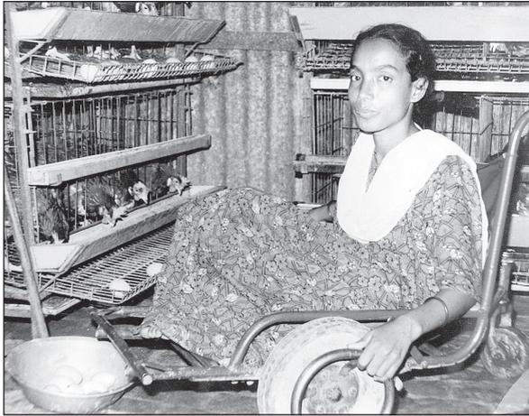
Figure 7.48. Au Bangladesh, les chariots peu élevés sont principalement utilisés par les femmes handicapées car ils sont adaptés au déroulement d'activités au niveau du sol.
