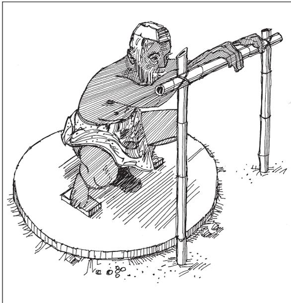
Figure 7.58. Une barre d'appui permettant de s'accroupir.
