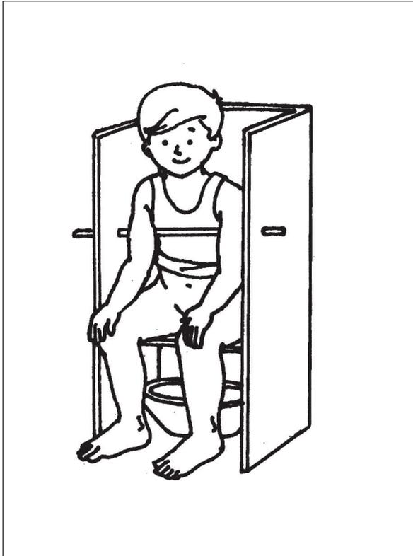
Figure 7.22. Un siège équipé d'accoudoirs relevables. Ils sont fixés au dossier du siège par un boulon, grâce auquel ils pivotent verticalement.
