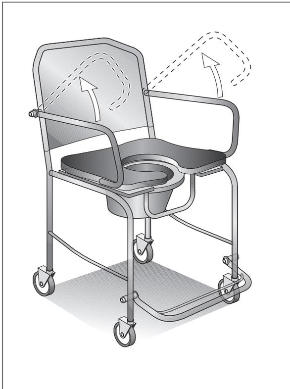
Figure 7.21. Un siège équipé d'accoudoirs relevables. Ils sont fixés au dossier du siège par un boulon, grâce auquel ils pivotent verticalement.
