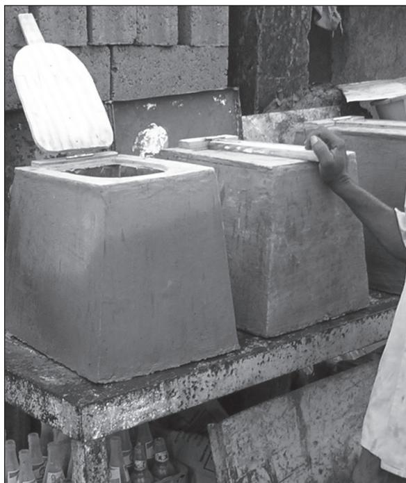
Figure 7.27. les sièges des toilettes en béton sont vendus avec abattant articulé en bois, pour atténuer les odeurs et réduire l'apparition des mouches.
