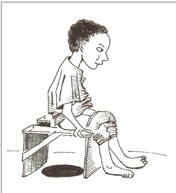
Figure 7.35. Un tabouret de toilette en bois, qui peut être utilisé au-dessus des latrines familiales à fosse. Ecartement entre les planches : 10 cm; adapté à un enfant. La planche avant fait office d'anti-éclaboussures.
